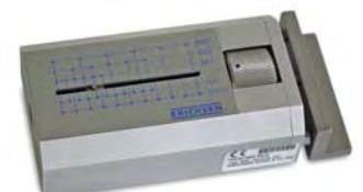
SCROLLRULER 295/XV: universelles Gitterschnittlineal, durch einfaches Drehen des Rändelrades einstellbar.
