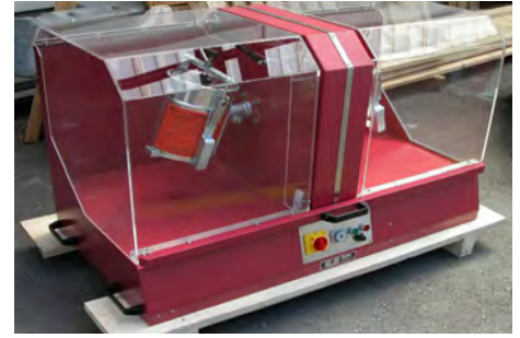
Doppelseitiger Labormischer MIXOMAT A 3/3 mit Spezialhalterungen für Flaschen
