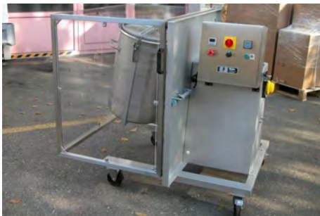
MIXOMAT B 100/- BV, fahrbar; Spezialmischer für pharmazeutische Anwendungen, für 100 Liter Behälter, mit Halterung Typ BV, mit Schutzkäfig, komplett rostfreie Ausführung; mit Spezialsteuerung für genau reproduzierbare Mischungen
