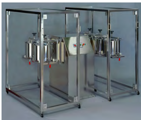
MIXOMAT Spezial Reinraum, Spezialmischer für den Reinraum mit Halterungen für zwei resp. drei 20 Liter Behälter, mit fahrbaren Schutzkäfigen; zum Suspendieren von Insulin in propanolischer Lösung
