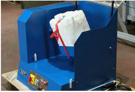
Labormischer MIXOMAT A 25/- mit spezieller Gurten-Halterung, angepasst an 25 Liter Kanister; mit Schutzhaube aus Plexiglas
