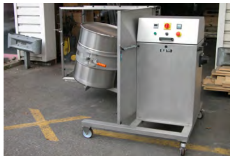
Fassmischer MIXOMAT B 150/- HR, fahrbarer Mischer für pharmazeutische Anwendungen, für 150 Liter Behälter, mit Halterung Typ HR, mit Schutzkäfig, komplett rostfreie Ausführung; mit Spezialsteuerung für genau reproduzierbare Mischungen
