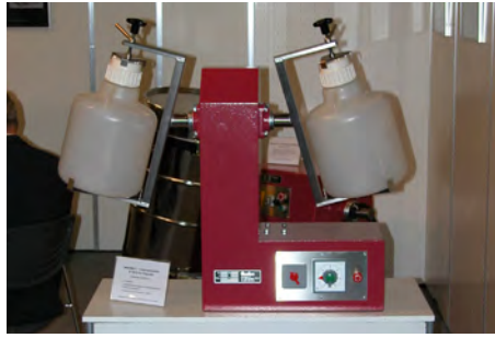
Doppelseitiger Labormischer MIXOMAT A 3/3 mit Spezialhalterungen für Flaschen
