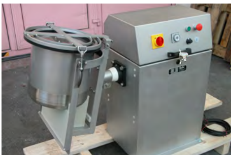
Fassmischer MIXOMAT B 60/- BV, komplett rostfreier Mischer für pharmazeutische Anwendungen, für 60 Liter Behälter; mit Adapter zum Mischen mit 30 Liter Behältern
