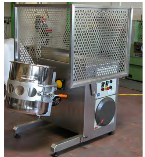
Fassmischer MIXOMAT B 75/- HR, für den Reinraum, in ATEX-Ausführung, mobile Ausführung, mit auswechselbarer Halterungen für 75 oder 30 Liter Behälter; mit Schutzkäfig
