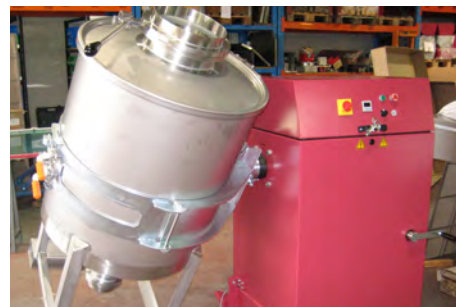
Manuell kippbarer Fassmischer MIXOMAT CM 400/- HR Spezial für und mit 400 Liter Container
