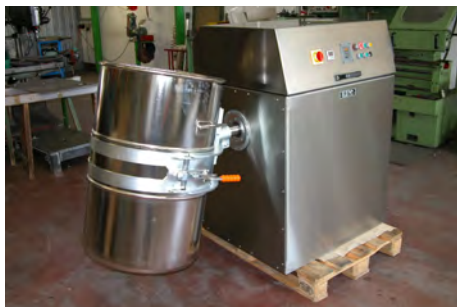
Elektrisch kippbarer Fassmischer MIXOMAT CE 200 HR, in Standardausführung für pharmazeutische Anwendungen; für 200 Liter Behälter, mit Halterung HR
