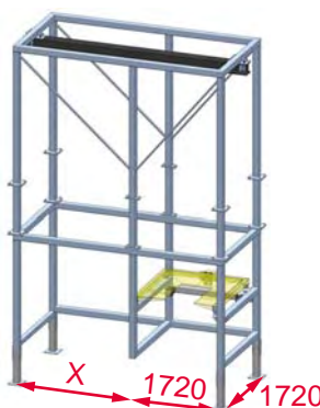
Abb.: Brückenportal mit Laufbahnschiene und angedeutetem Auflagetisch
