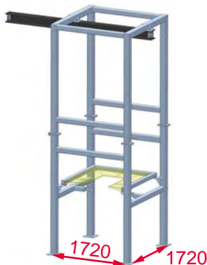
Abb.: Kragarmportal mit Laufbahnschiene und angedeutetem Auflagetisch
