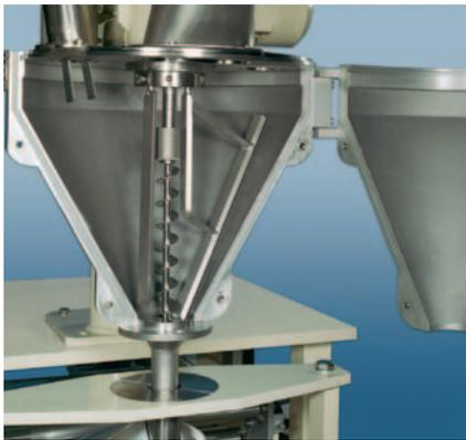
Die Trichter der grösseren Schneckendosierer werden in einer aufklappbaren Ausführung angefertigt. Dies ermöglicht schnelles Reinigen bei Produktionsumstellungen.
